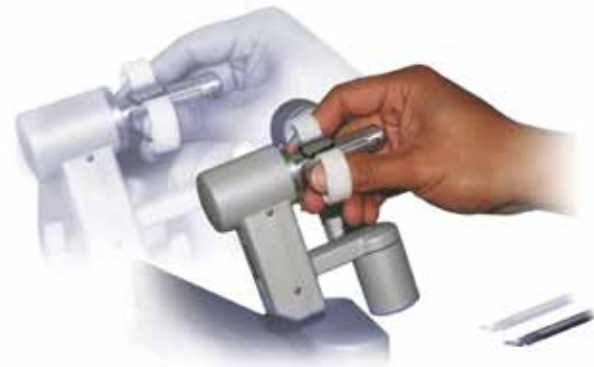
図2 モーションスケールリング+手ぶれ補正機能 手術器具が実際の手の動きより細かく動き、かつ手の震えの影響を除去します。
