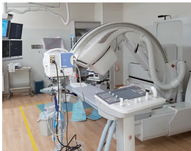
写真-5 C-アームX線透視装置Ultimaxを装備した内視鏡透視室2
